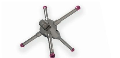
Die Sternaster vom Typ V haben einen Gewindeanschluss und können direkt montiert werden. Sie haben in der Regel zwei bis vier Tastarme in radialer Richtung und einen in axialer Richtung. Die axial ausgerichteten Tastarme werden je nach Konfiguration zum Klemmen des rotierenden Sterns verwendet.
