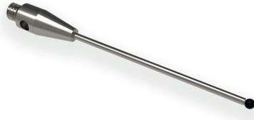
Ein gerader Taststift in seiner einfachsten Form. Der Schaft ist durchgehend zylindrisch und kann aus nichtrostendem Stahl, Hartmetall, Keramik oder CFK gefertigt sein. Diese Taster setzen sich in der Regel aus drei Komponenten zusammen: Halter, Schaft und Kugel. In wenigen Fällen werden Halter und Schaft monolithisch aus nichtrostendem Stahl gefertigt. Die Kugelwerkstoffe entnehmen Sie der Werkstoffübersicht.
