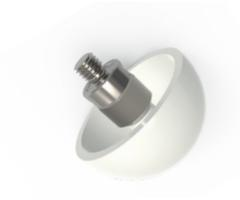
Hohlhalbkugeltaster eignen sich zur Messung von jenen Messelementen, die einen großen Durchmesser der Tastkugel erfordern, bzw. eine reduzierte Bauhöhe. Im Gegensatz zu Scheibentaster, die nur radiale Antastungen zulassen, können mit Hohlhalbkugel auch stirnseitige Messungen erfolgen. Als Antastbereich ist die gesamte Hohlhalbkugeloberfläche erlaubt.
