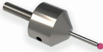
Ein gerader Taster mit einem langen (12,5mm) Gewinde M5. Die Schaftform ist durchgehend zylindrisch und kann aus folgenden Werkstoffen gefertigt werden: nicht rostendem Stahl, Hartmetall, Keramik oder CFK. Diese Taster bestehen meistens aus drei Komponenten: Halter, Schaft und Kugel. In wenigen Fällen werden Halter und Schaft monolithisch aus nicht rostendem Stahl gefertigt. Die Kugelwerkstoffe können Sie aus unserem Werkstoffübersicht entnehmen.
