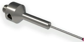
Feintaster werden hauptsächlich zur Messung kleiner Bohrungsdurchmesser eingesetzt. Durch den abgestuften Grundkörper wird eine größere Gesamtlänge bei hoher Stabilität erreicht. Der Schaft ist durchgehend zylindrisch und aus Hartmetall gefertigt. Diese Taster bestehen aus drei Teilen: Halter, Schaft und Kugel.
