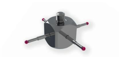
Der Würfelstern ist ein 4-Wege-Sternaster ohne direkten Gewindeanschluss. Das Grundwerkstoff der Standardausführung ist Titan. Zur Befestigung am Messsystem ist eine Klemmschraube erforderlich. Zur Befestigung am Messsystem ist teilweise eine Klemmschraube erforderlich.
