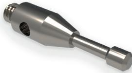
Zylindertaster werden zum Antasten dünnwandiger Bleche und scharfer Kanten verwendet. Sie werden dort eingesetzt, wo ein genaues Antasten mit einer Kugel nicht möglich ist. Die Stirnfläche des Antastelementes ist bei diesem Typ plan geschliffen.
