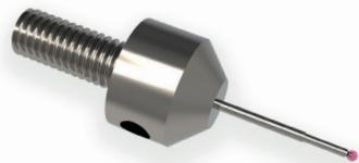
Ein gerader Taster mit einem einfach oder mehrfach abgestuften Schaft, der aus Hartmetall gefertigt wird. Das Gewinde M5 ist 12,5mm lang. Diese Taster bestehen aus drei Komponenten: Halter, Schaft und Kugel. Die Kugelwerkstoffe können Sie aus unserem Werkstoffübersicht entnehmen.
