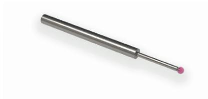
Taststifte bestehen aus einem Schaft und einer Kugel und haben kein Gewinde. Für den Einsatz dieser Taststifte sind entsprechende Klemmhalter erforderlich. Vorteil: schnelles Umrüsten möglich; preiswert und flexibel. Diese Ausführung hat einen abgesetzten Schaft.
