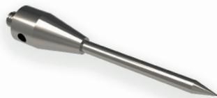
Tastspitzen sind eine Sonderform von geraden Tastern, bei denen der Kugelradius gegen Null geht. Beim Antasten ist zu beachten, dass Oberflächen sehr leicht durch die Spitze beschädigt werden können und im Gegenzug die Spitze selbst sehr empfindlich für Abnutzung oder Beschädigung ist. Der Haupteinsatz liegt bei sehr kleinen Antastflächen oder beim selbstzentriertem Antasten von Bohrungen.
