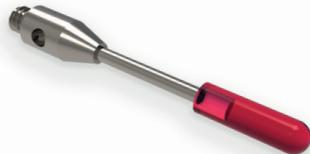
Zylindertaster werden zum Antasten dünnwandiger Bleche und scharfer Kanten verwendet. Sie werden dort eingesetzt, wo ein genaues Antasten mit einer Kugel nicht möglich ist. Die Stirnfläche des Antastelementes ist kugelförmig und wird zum axialen Antasten verwendet.
